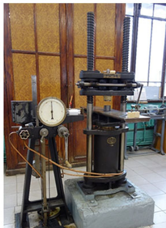
Лаб. работа № 5: «Определение модуля упругости материала (сталь)».
